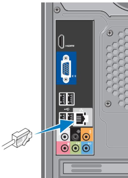
Δεν απαιτείται σύνδεση δικτύου για την ολοκλήρωση της εγκατάστασης του υπολογιστή, αλλά εάν διαθέτετε ήδη υπάρχουσα σύνδεση δικτύου ή Internet που χρησιμοποιεί καλωδιακή σύνδεση (όπως ένα οικιακό καλωδιακό μόντεμ ή υποδοχή Ethernet), μπορείτε να το συνδέσετε τώρα. Χρησιμοποιήστε μόνο ένα καλώδιο Ethernet (υποδοχή RJ45). Μην βάζετε στην πρίζα το καλώδιο τηλεφώνου (θύρα RJ11) μέσα σε μια θύρα δικτύου.
